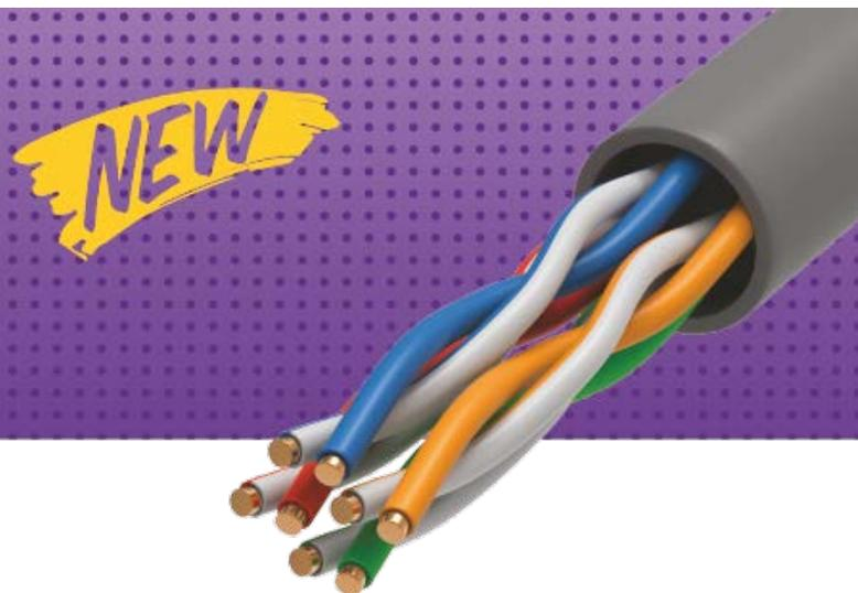
Используется для построения операторских сетей широкополосного доступа (последняя миля) и небольших корпоративных локально-вычислительных сетей. Витая пара для внутренней и внешней прокладки имеет рабочий диапазон частот до 100 МГц, медные токопроводящие жилы, экранированное (F/UTP) и неэкранированное исполнение (U/UTP).
