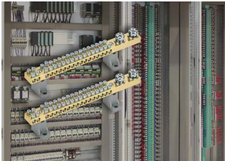
Предназначены для электрического и механического соединения фазных, нулевых и рабочих защитных проводников в электрощитовом оборудовании и электроустановках напряжением до 400 В.
