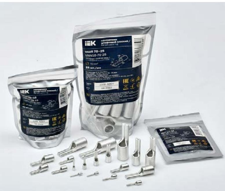
Используются для оконцевания проводов и кабелей с медными жилами различного сечения в электрических цепях переменного и постоянного тока. Подключаются к автоматическим выключателям и прочим электрическим устройствам с ограниченной шириной контактной клеммы.
